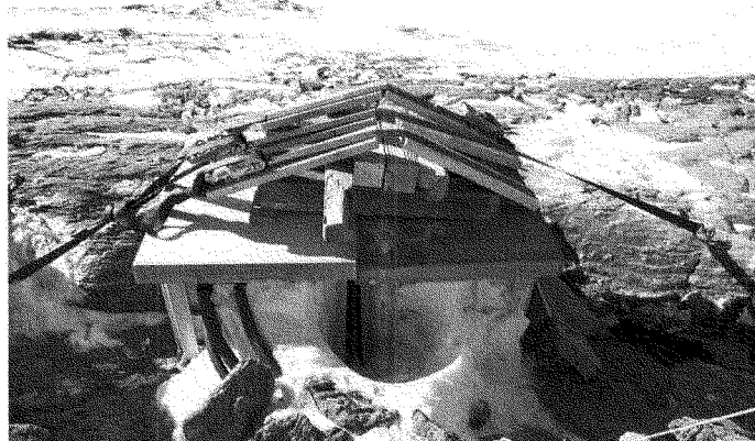
写真Ⅲ.3.7.1-1 岩島カメラ設備用プラスチックケース ラッシングの様子
