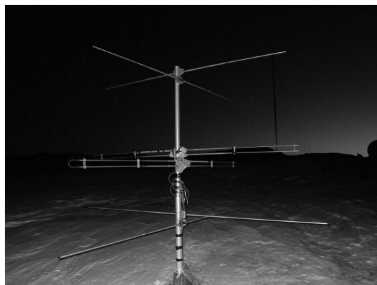
写真Ⅲ. 3. 2. 3. 1. 2-2 加速度センサを付けたアンテナ
