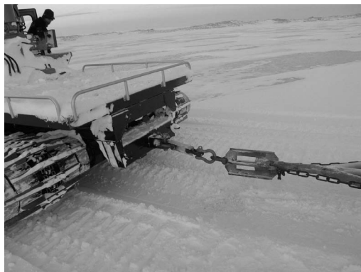
(a) 試作した連結補助部品
