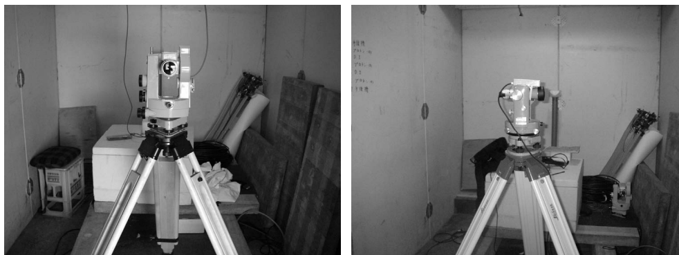
写真Ⅲ.3.2.4.1.1-2 従来の観測で使用していたFT型磁気儀（左）と更新後のFT型磁気儀（右）
