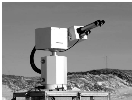
写真Ⅲ.3.2.4.2.2-1 設置したスカイラジオメータ
