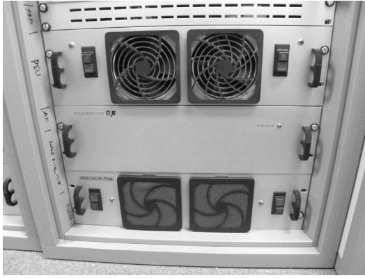
写真Ⅲ.3.2.1.1.3-1 追加した電源ユニット（下段）と電源線（青線）
