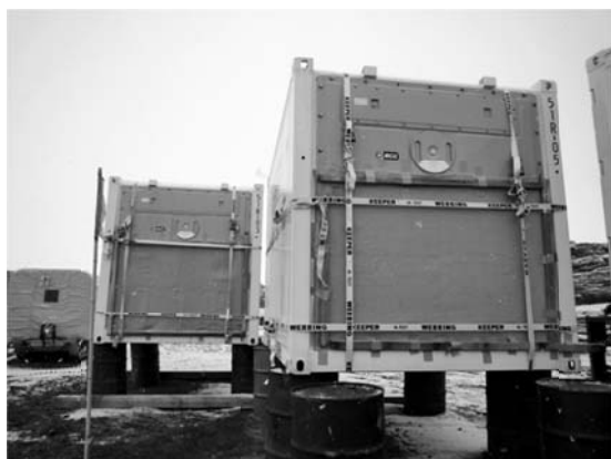
写真Ⅲ.6.3-3 リーファーコンテナ養生状態
