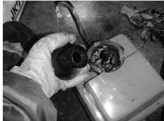
写真Ⅲ.4.5.8-2 加熱バーナー失火後の分解整備
