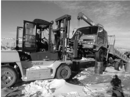
写真Ⅲ.4.5.10-3 廃棄予定車両 かさ上げ
