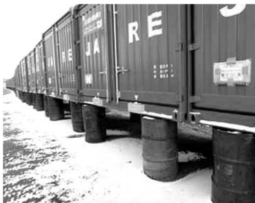
写真Ⅲ.6.3-2 フォークリフト爪差込穴目貼り状態
