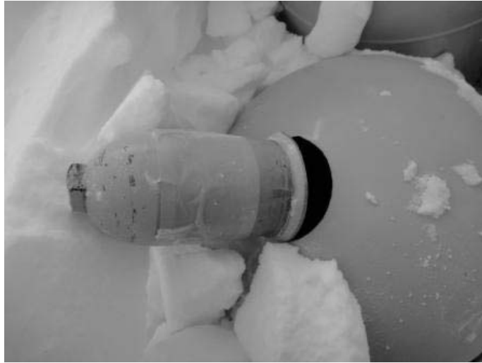
写真Ⅲ. 6.2.4-8 プロパンガスボンベネック部折損状況(拡大)
