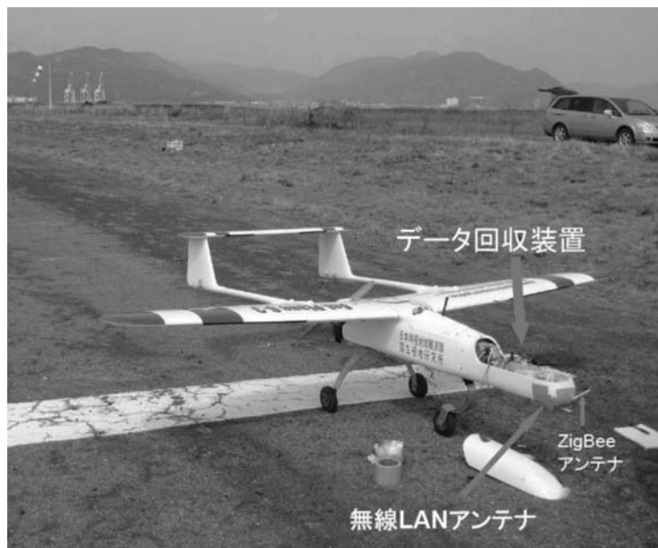
図 4 データ回収装置の小型無人飛行機への搭載
