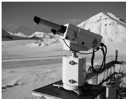
図 1 ニーオルスン・ラベン観測所屋上に設置されたスカイラジオメータ POM-02
