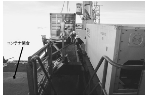
写真4 左舷前部にある貨物取り出し用コンテナ架台 Photo. 4. Container deck at portside.
