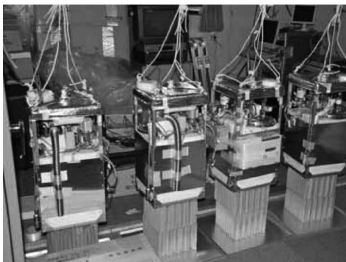
図 2 小型クライオサンプラーの外観図。サンプラー本体下部に、紙ハニカム製クラッシュパッドを取り付けている。
