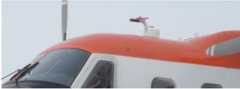
図 2 Polar2 上部の空気取り入れ口。駐機中は取り込み口にキャップをしている（写真中の黒色部品）。 Fig. 2. Air intake on top of the aircraft, Polar2.
