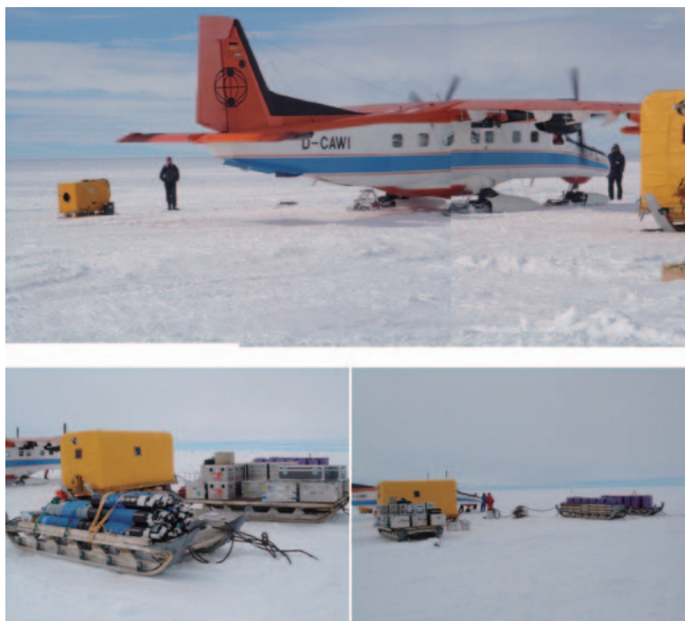
図 6 駐機場における航空機運航用物資配置の様子. 上図: 航空機用発電機 (GPU : Ground Power Unit) (左奥). 下左図: 酸素及び窒素ボンベ (手前), 観測機器用発電機 (奥の幌櫃), 航空機予備部品 (奥のジュラルミン箱). 下右図: 燃料櫃の配置 (右奥).
