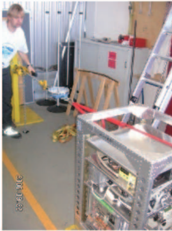
図 A1 請負業者(ドイツ、Optimare 社)による測器固定試験の様子。
