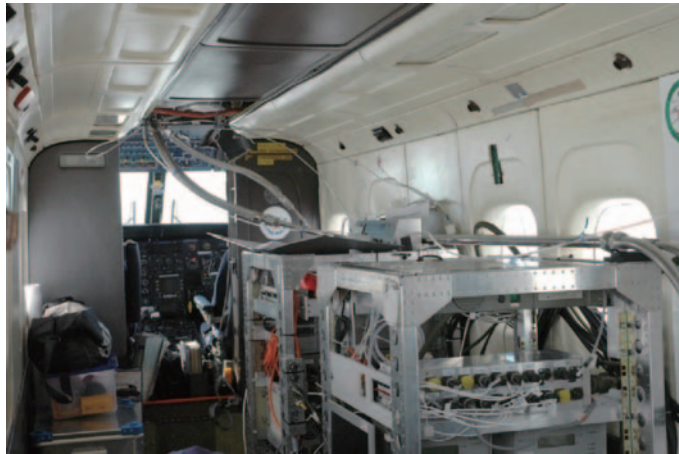
図 3 機内の測器とサンプル大気用の配管。 Fig. 3. Instruments and tubing in the aircraft.
