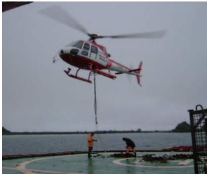
Photo 13 ヘリコプターでのスリング作業 Photo 13 Sling operation by AS350BA helicopters.
