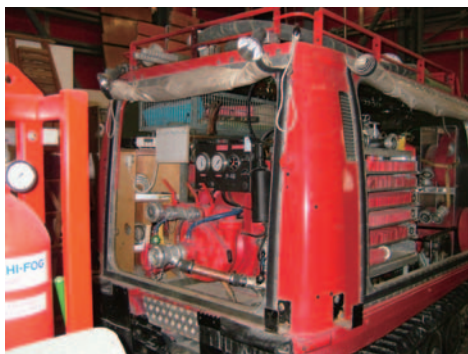
Photo 19 ヘグランド雪上車に装備された消防ポンプとホース
