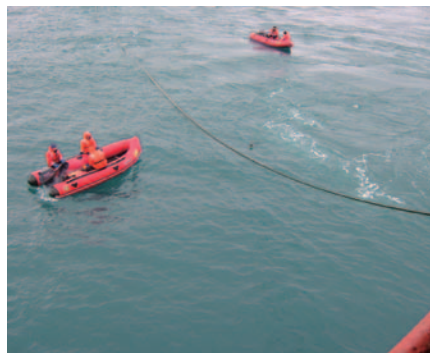
Photo 30 ゴムボートによる燃料ホースの展開
