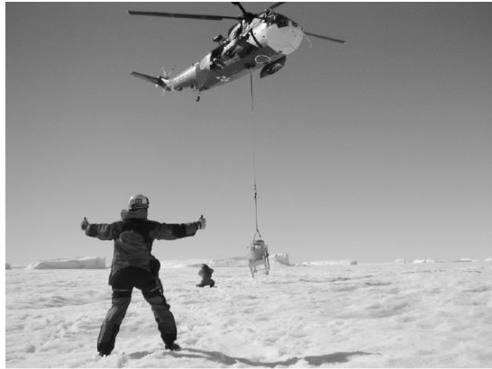
図 4 回収気球 2 号機ゴンドラのスリング輸送。隊員がホイストにより水上に降下し、パラシュートの切り離しとゴンドラの処理を行った。
