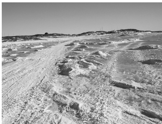
図 6 海水裸氷帯での車両のトレース（右側の薄いトレースはブリザード後数回踏み固める作業を行った滑走路想定地、左側が昭和基地ととっつき岬間の海水上路ート）
