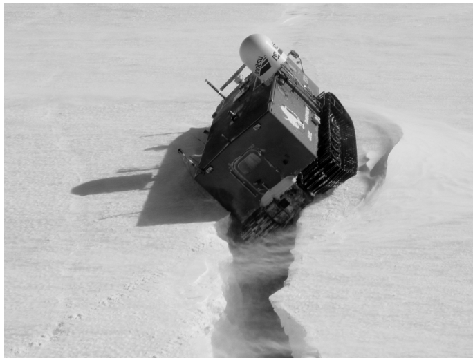
図 9 上空から見た、クレバスを踏み抜き傾いて停止した大型雪上車
