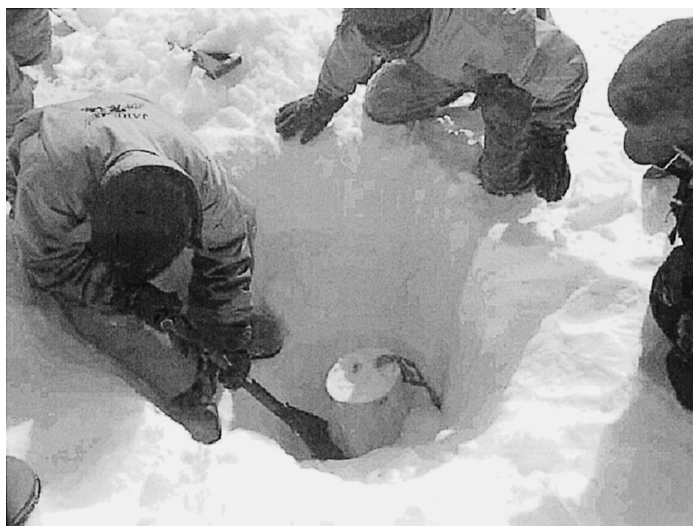
図5 掘り出し中のペネトレータ Fig. 5. Penetrator body under excavation.
