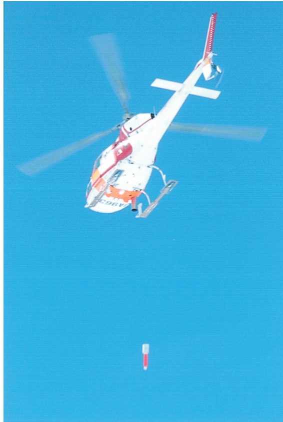
図4 ヘリコプターから投下されたペネトレータ Fig. 4. Penetrator released from a hovering helicopter.
