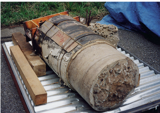
図2 基礎コンクリートピア部分 Fig. 2. The pier of the concrete foundation.
