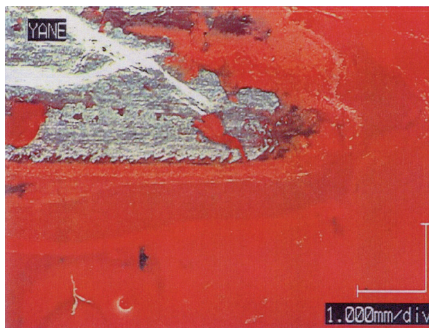
図1 屋根パネルの塗膜破断面
