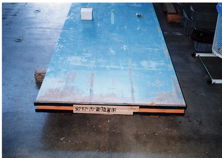
図4 両端 106 mm を切断した壁パネル試験体 Fig. 4. The test specimen of the wall panel cut from 1.212 m to 1 m width.
