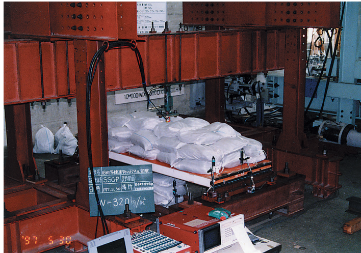
図5 壁パネルの等分布荷重裁荷試験
