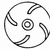
図 16 チップ吸引ポンプ; うずまき型軸流ポンプ Fig. 16. Chip pump (whirlpool type).
