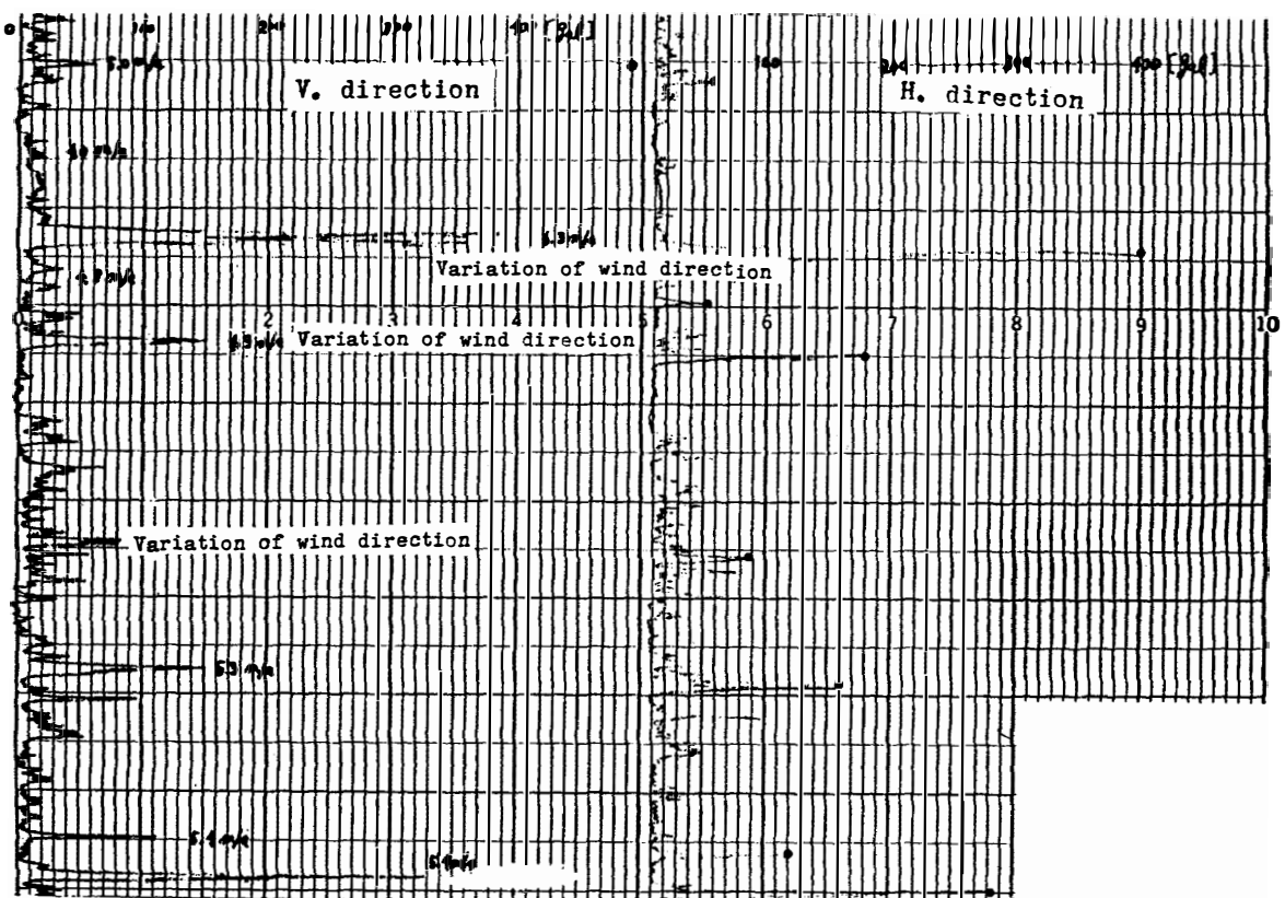
図10 風速、風向の変化に対応するV、H方向の振動加速度変化の例 (測定期間: 1984年1月19日, 1414-1423)
