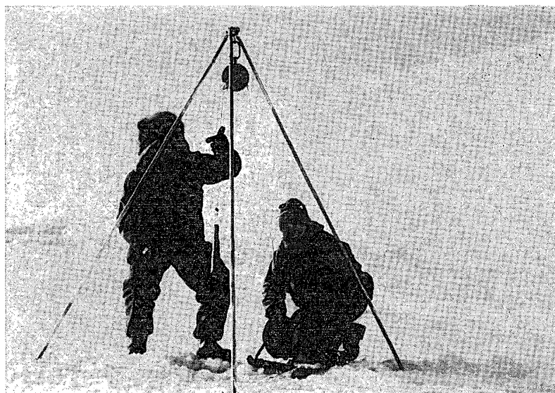
図 7 昭和基地付近でのワイヤーによる測深
