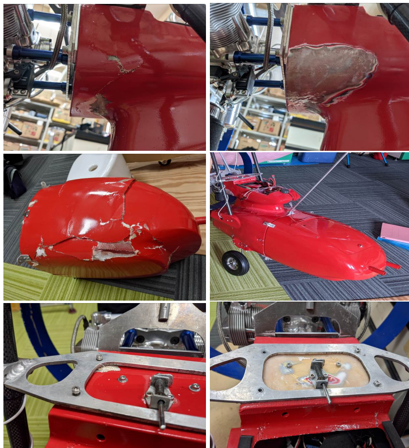
図 III.52 損傷した機体の補修前（左）と補修後（右）の状況
