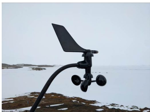
図 III.46 交換したアネモメータの（下部の三杯が風速計）
