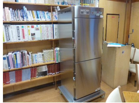
図 III.69 保温庫 (電機保温庫 ホシザキ製 NB-37F)
