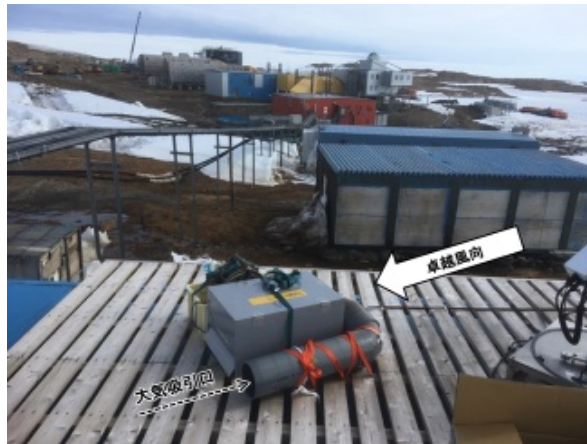
図 III.48 ^7\text{Be} 分析用 HV サンプラーの設置状況
