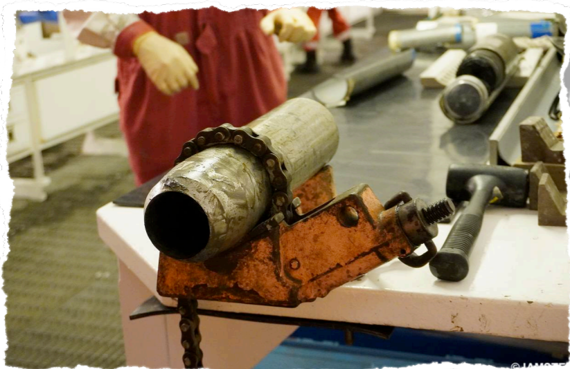
カッティングシュー 一番下に取り付け、海底に突き刺さる部分
