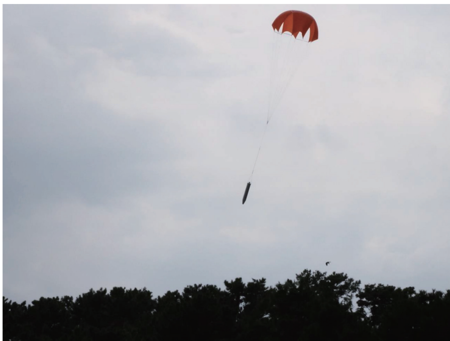
図 3 三保飛行場で行われたパラシュート付きペネトレータ投下試験.
