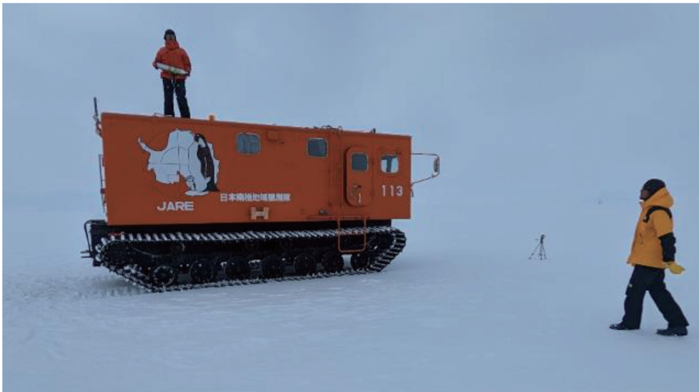
図 11 H128 の大陸氷床上で行った雪上車の屋根上からのペネトレータ投下試験。
