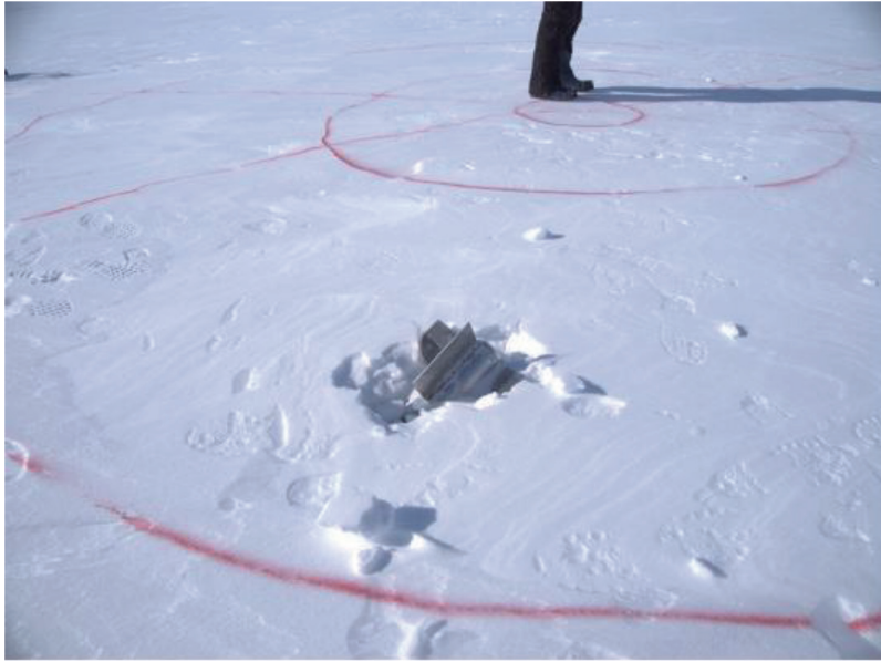
図 13 高度 75 m から投下したダミーペネトレータ。 Fig. 13. The dummy penetrator dropped from 75 m height at site S16.
