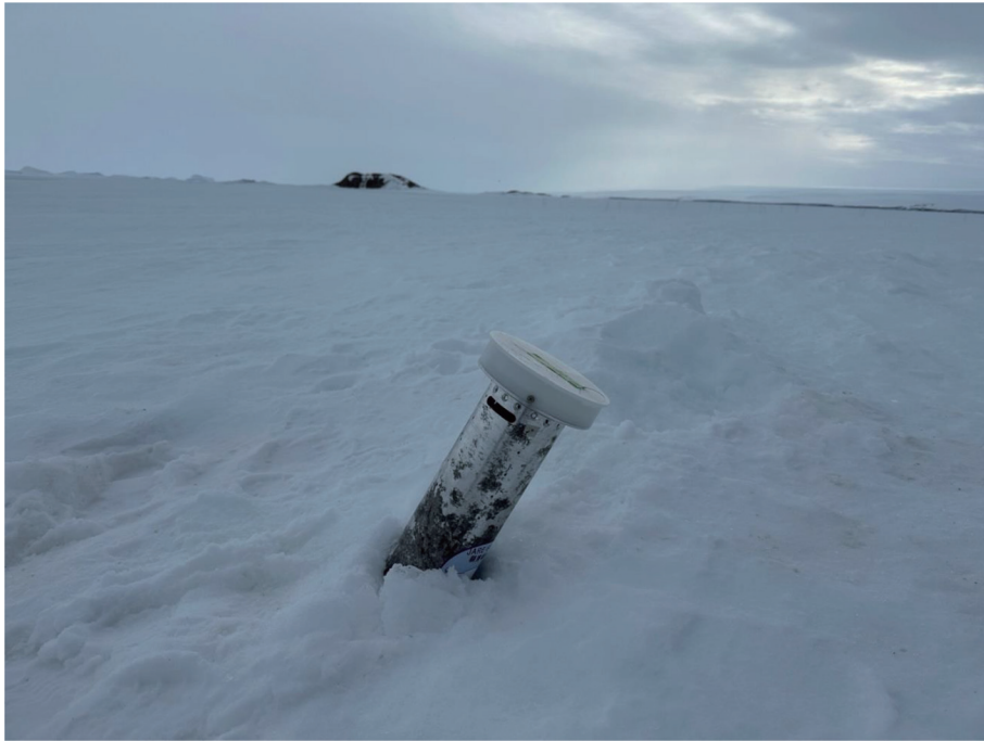
図4 北の浦海上に設置された観測用ペネトレータ。
