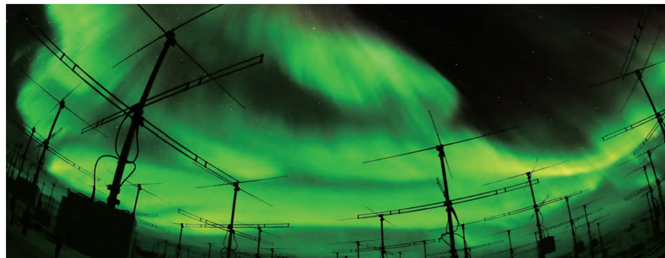
昭和基地で運用中の大型大気レーダー（PANSY）
