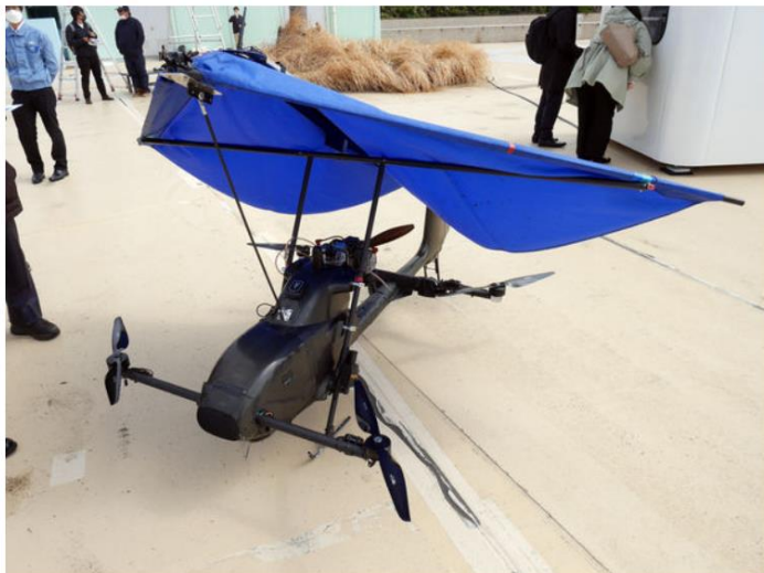
実証実験で使用されたVTOLカイトプレーンVK21-01「不死鳥」。不死鳥という名は、半年間に渡る実証飛行で幾度となく傷つきながらも必ず帰還してきたことに由来する。
