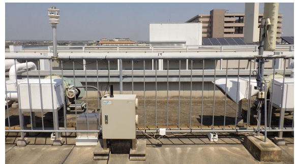
図 2 国立極地研究所屋上に設置された地デジ放送波の伝搬遅延量計測装置
