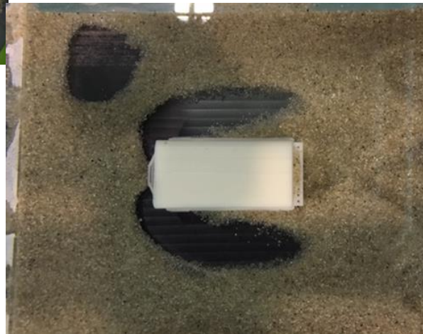
図26 砂の堆積・侵食状況の変化（新型機と従来機の比較）
