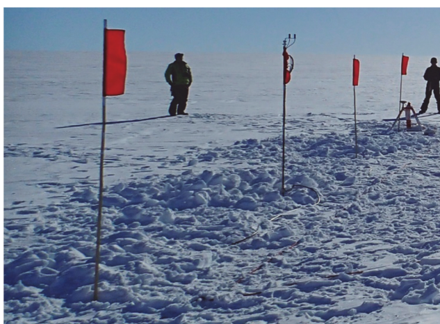
図Ⅱ.2.3.2.2-5 ApRES 埋設後（手前から2つ目赤旗下にロガー及びバッテリーBOX）風景
