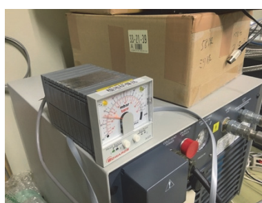
図Ⅱ.2.3.1.2-1（左） 仮組み立て・接続が完了した新受信機のクライオスタットと真空ポンプ
