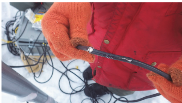
(アルゴスアンテナケーブルの断線)
