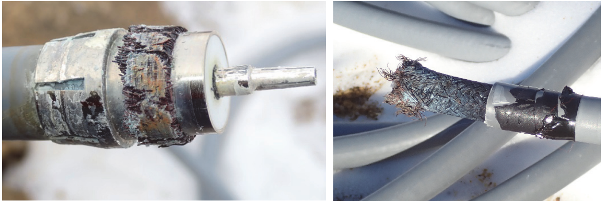
写真Ⅲ.3.4.3.1-1 腐食した F13 コネクタ (タワー基部) (左) と腐食した伝送ケーブル (基部⇄PA) (右)
