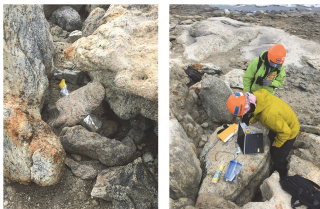
図Ⅱ.2.4.6.2-1 ラングホブデ袋浦-1に設置した温湿度気圧計（左）と作業風景（右）
