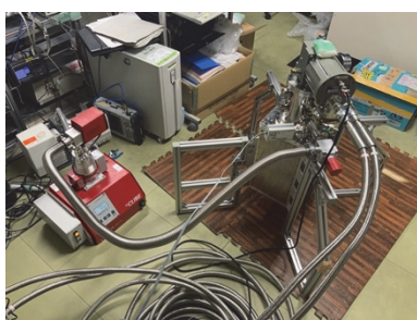
図Ⅱ.2.3.1.2-1（左） 仮組み立て・接続が完了した新受信機のクライオスタットと真空ポンプ
