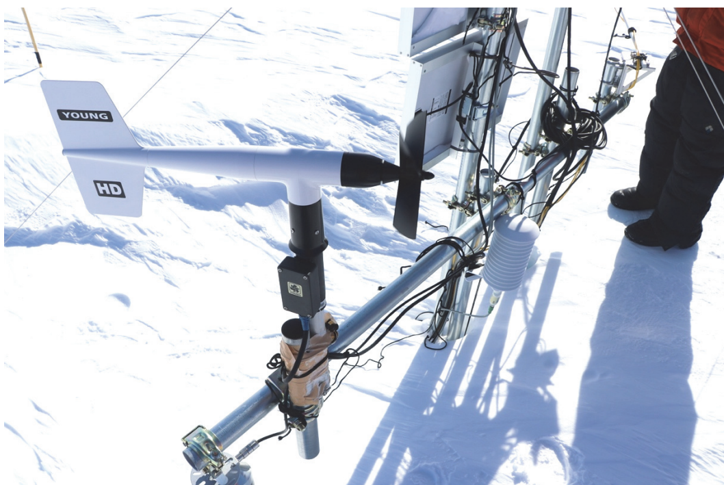
図Ⅲ.6.5.9-4 嵩上げ前の AWS 下部の様子
