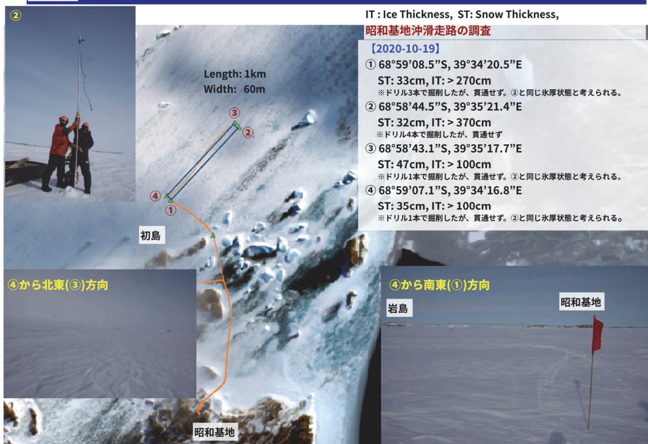
図Ⅲ.2.3.4-1 昭和基地沖滑走路設定のための海氷調査。背景はSentinel-2衛星可視画像(ESA)。
