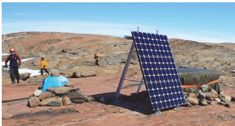
写真 II.2.4.8-1 ルンドボックスヘッタ地震計・インフラサウンド収録ボックスおよび地震計外観
