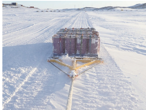
図Ⅲ.4.1.12-8 トーバーの付根に雪を抱えている
