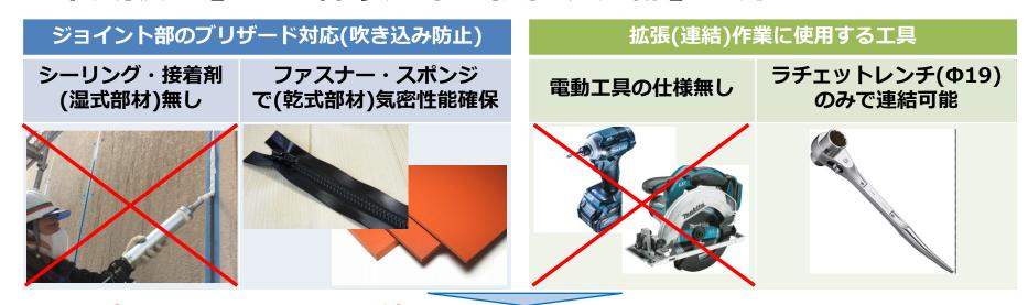
『(釘等を)**打つ**』、『(シーリング等を)**塗る**』などの作業はなし。 『(ボルト等を)**締める**』、『(ファスナー等を)**閉める**』、『(床等を)**置く**』だけでジョイント完了
