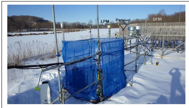
図 2. 観測点の風景。高さ 2m の位置にディストロメーター防風ネット内に天秤式降雪量計、降雪粒子自動観測装置を設置
