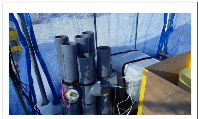
図 3. 降雪粒子自動観察装置。塩ビパイプ内に上向きに置いた顕微鏡に落下した降雪粒子を撮影する。撮影確率を上げるため 6 本設置した。
