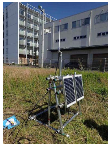
図 2. トレーニングフィールドにおける微気象観測装置の試運転の様子。
