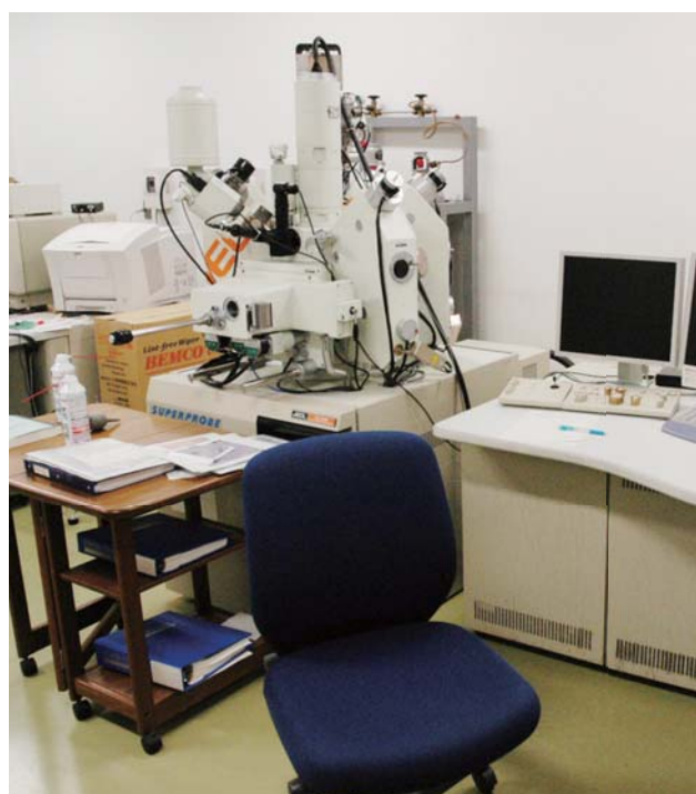
地質学・岩石学の武器である電子線マイクロアナライザ (EPMA)
