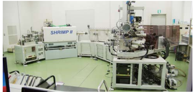
鉱物の年代測定を行う二次イオン質量分析計(SHRIMP)
