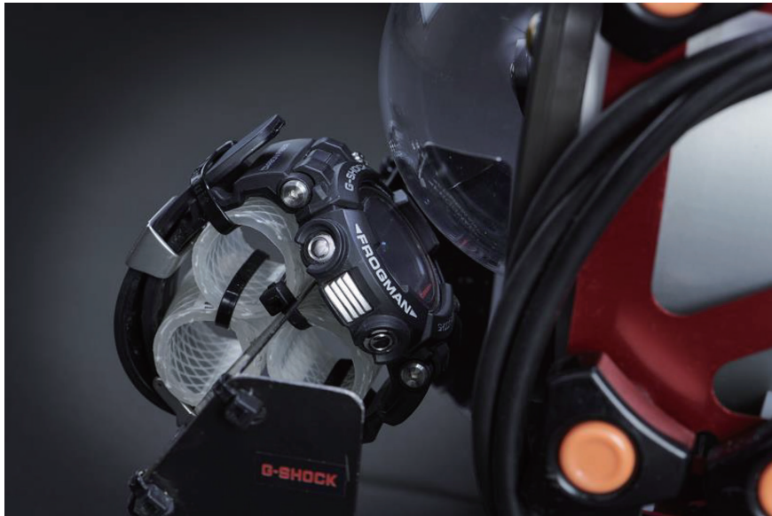
図 5 航法デバイスとして ROV 機首部に取り付けた GWF-D1000
