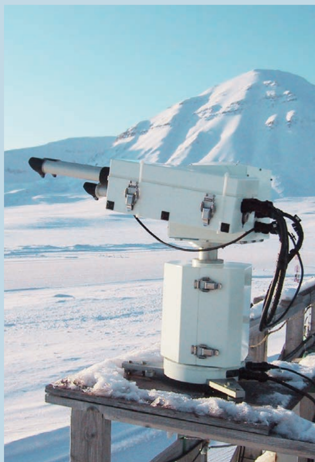
太陽や空の明るさを測定して大気中の微粒子、エアロゾルを測る観測機
