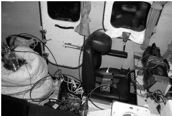
写真Ⅲ.7.1.6-3 (左) ラドン濃度観測機器の車内での展開の様子。(右) 車外に設置したシーロメーターの様子。(平沢撮影)
