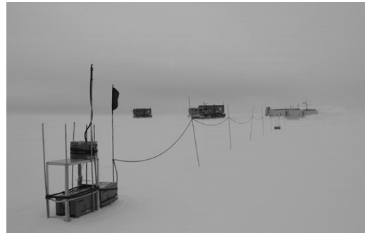
図Ⅱ.2.2.4.2-2 S17でのエアロゾル粒子の捕集の様子
