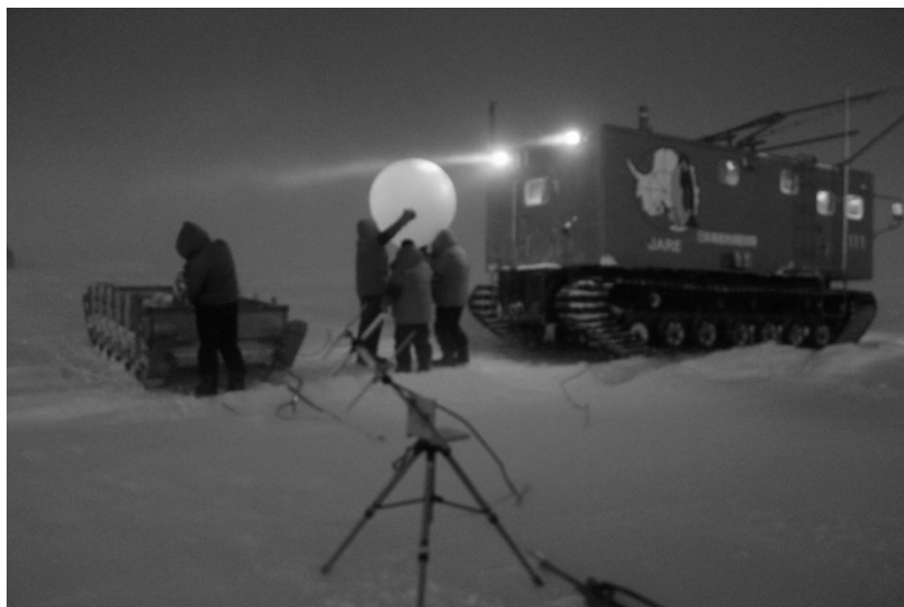
写真Ⅲ.7.1.6-2 中継拠点におけるゾンデ観測の様子。気球へのガス充填。
