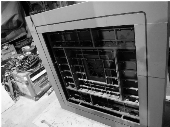
写真Ⅲ. 4. 5. 5-7 正面扉組立て (4/20)
