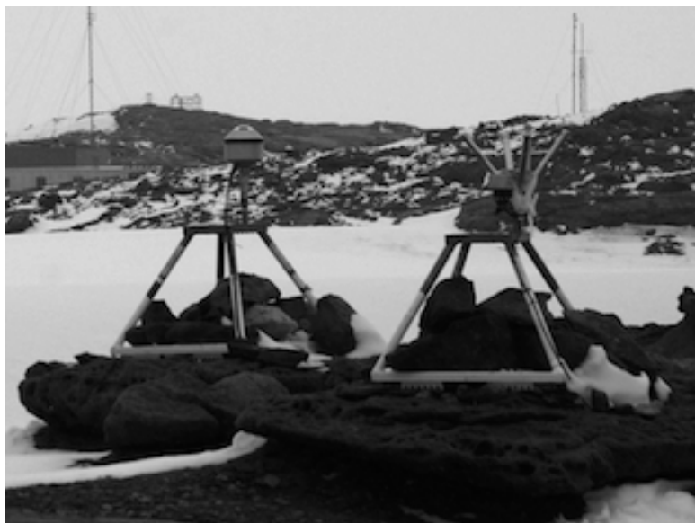
写真Ⅱ. 2. 2. 13. 1-1 SkyPot と雲量・雲高計の設置状況
