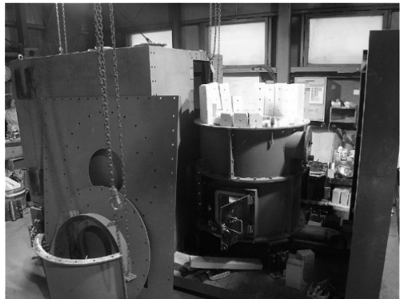
写真Ⅲ. 4. 5. 5-8 二次燃焼室サイクロン2段目 (4/24)
