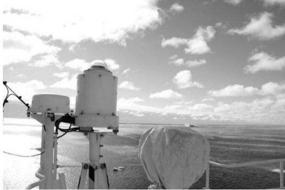
写真Ⅱ.4.2.1-1 06 甲板に設置した全天カメラ
