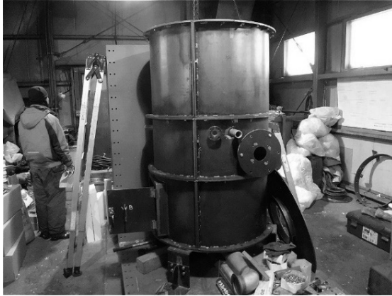
写真Ⅲ. 4. 5. 5-3 二次燃焼室サイクロン仮組 (3/31)
