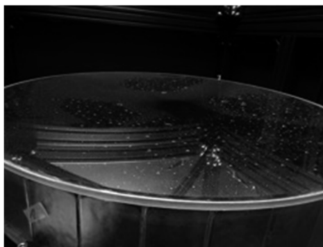
写真Ⅱ.2.1.1.2-3 クリーニング作業前の主鏡。58 次越冬期間における雨漏りが原因で、主鏡上に斑点状の汚れが多数目立つ。
