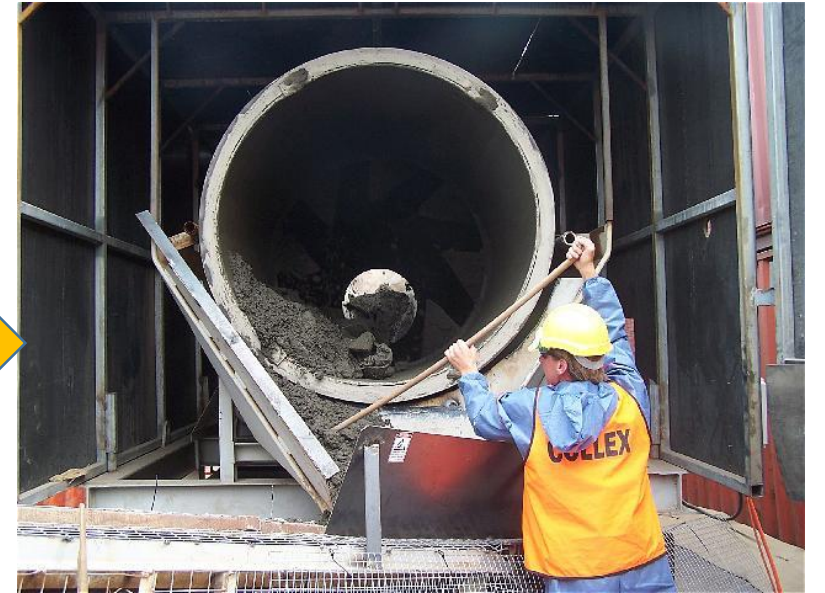
トロンメルと汚染土のミキシング
