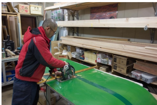
素材は建築部門より分けて いただいたガルバリウム鋼板
