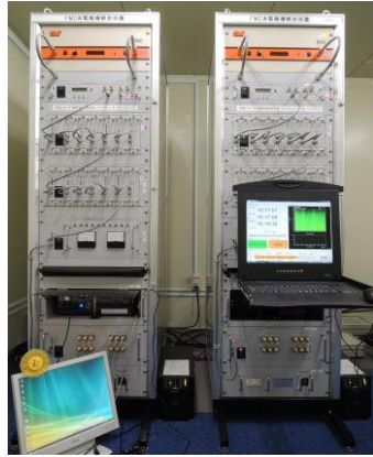
FMCW型電離層観測装置（イオノゾンデ）・デルタアンテナ
