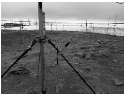
写真Ⅱ.2.1.1.2-7 (左) アンテナから脱落した信号ケーブル (右) M字コネクタと信号ケーブルの半田付け部分が、降雪時または融雪時の張力により剥がれた可能性が高い。
