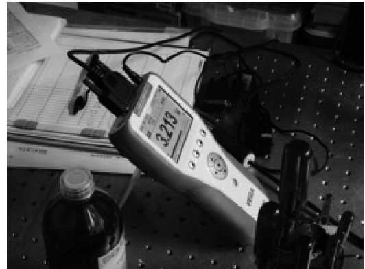
写真Ⅱ.2.1.1.2-1（左）クリーンブース内に設置されたレーザーヘッド内部の光学素子(右)1/18に記録したレーザー出力の表示、平均的には3.0Wを達成。
