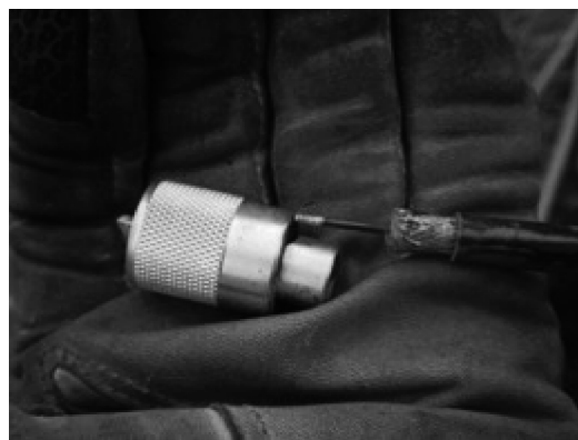
写真Ⅱ.2.1.1.2-7 (左) アンテナから脱落した信号ケーブル (右) M字コネクタと信号ケーブルの半田付け部分が、降雪時または融雪時の張力により剥がれた可能性が高い。
