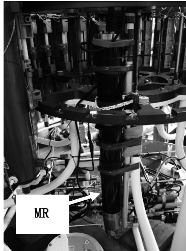
図Ⅱ.2.2.3.1-2 マイクロライダー6000をCTDフレームに搭載した様子。
