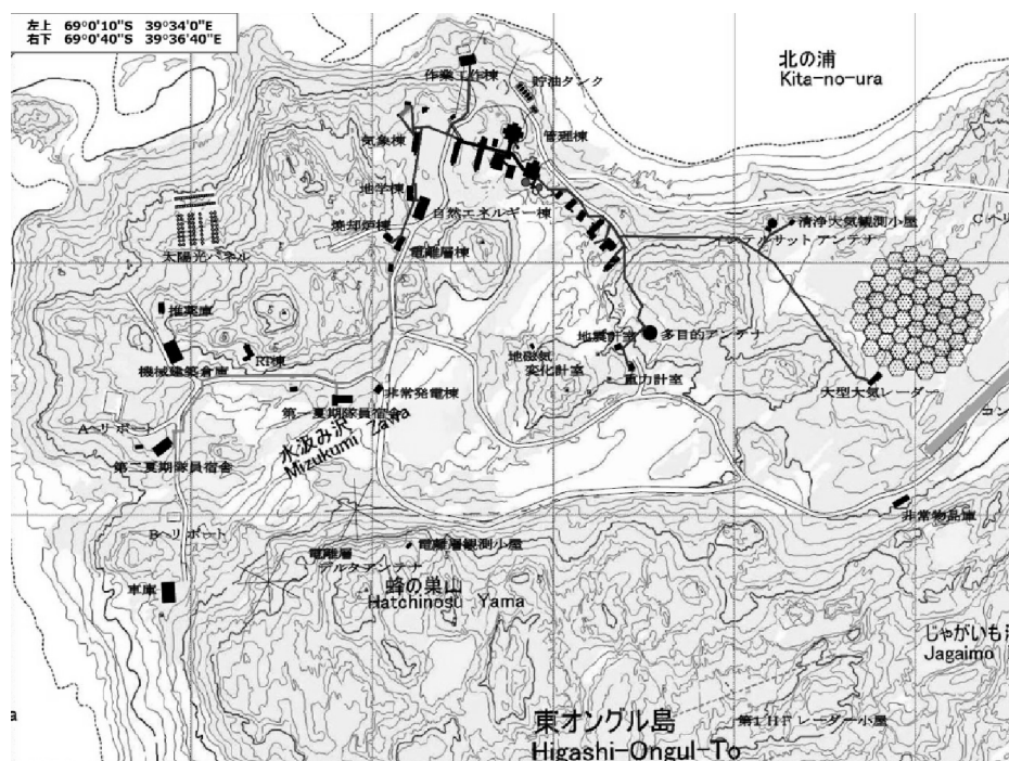
図Ⅲ.4.9.4-1 昭和基地ライフロープ配置図（電離層棟から夏宿舎方面は夏期間のみ設置）
