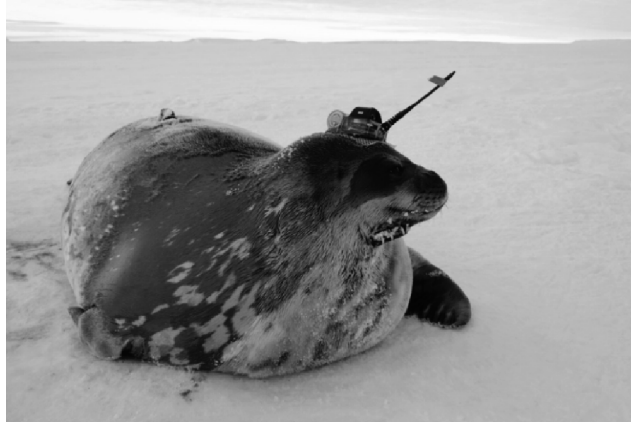
図Ⅲ.3.4.7.3-2 頭にCTDタグ、顎に加速度ロガー、背中にVHF発信器を装着したウェッデルアザラシ
