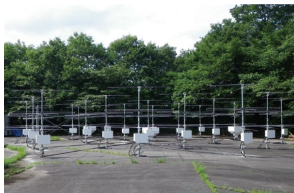
京都大学信楽MU観測所内で試験中の南極大型大気レーダー、PANSY用アンテナと送受信モジュール
