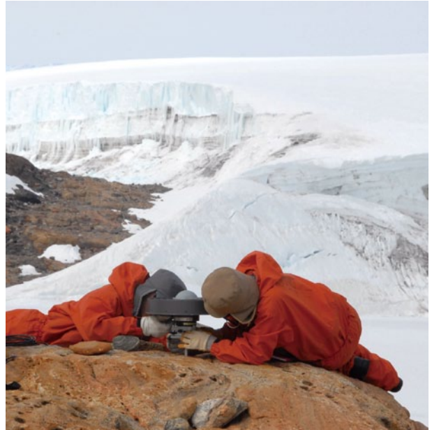
ルンドボグスヘッタでのGPS観測による地殻変動監視
