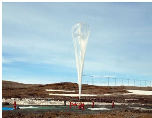
成層圏の二酸化炭素濃度測定のための回収気球実験風景
