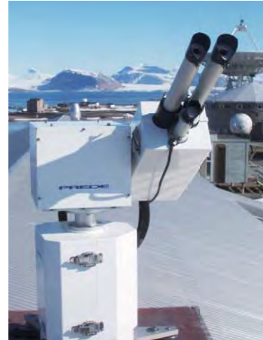
北極スバルバル、ニーオルスンにてエアロゾルを観測するスカイラジオメータ
