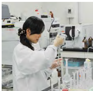
イオンクロマトグラフを用いた氷床コアの分析
