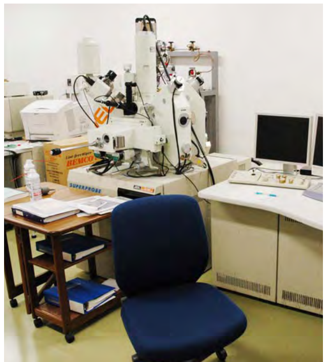
地質学・岩石学の武器である電子線マイクロアナライザ (EPMA)
