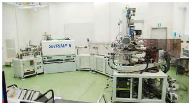
鉱物の年代測定を行う二次イオン質量分析計（SHRIMP）
