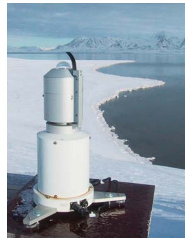
ニーオルスン観測基地全天カメラによる雲量の観測
