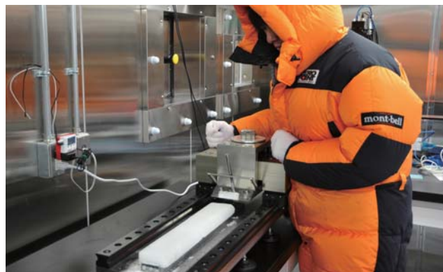
低温室内で、アイスコア分析のための前処理作業
