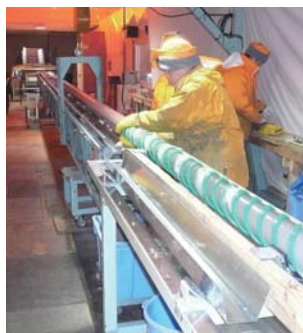
氷床深層掘削作業
