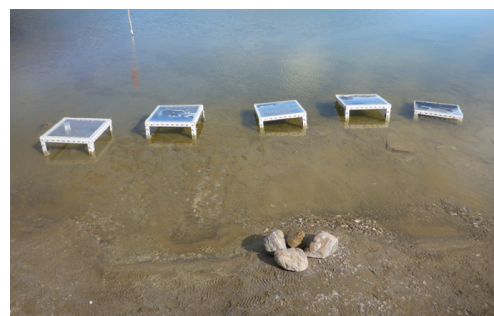
図2 弱光環境を作るための遮光テーブルの設置。テーブル毎に遮光板の透過度が異なる。
