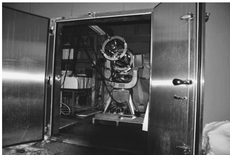
図 9 スノモ室に設営した赤外線望遠鏡
