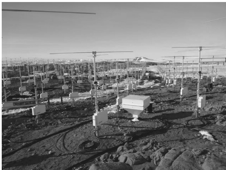
図 8 送受信モジュールを設置したアンテナ群 Fig. 8. PANSY antennas equipped with TRX modules.
