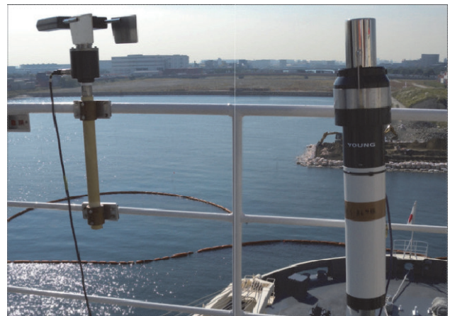
図 3.7.25 船舶に取り付けた飛沫計。(左)SPC 型、(右)雨量計型。
