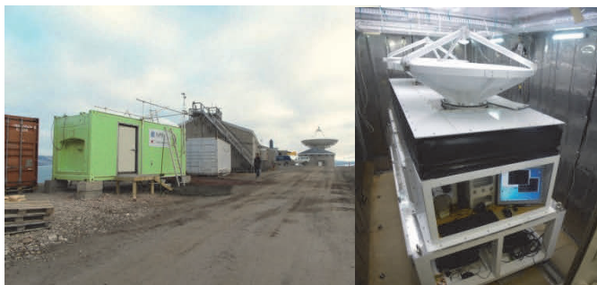
図4.4.1 ノルウェー スパールバル諸島ニーオルスンの国立極地研究所北極観測基地（78.9°N, 11.9°E）に設置された FALCON-A（右写真）とコンテナ（左写真、緑のコンテナ）。コンテナ天井のテフロン窓を通して、冬期もふくめ常時連続観測を行っている。
