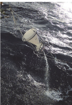
セジメントトラップの引き揚げ。（写真：菊地隆）
