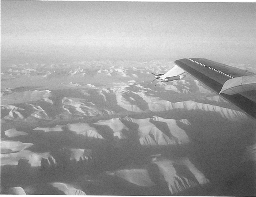
スピッツベルゲン島上空にて 翼端の測器は雲粒子計測プローブ
