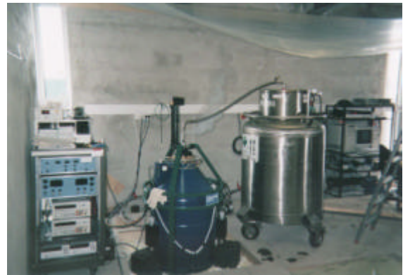
写真：液体ヘリウム補給中の超伝導重力計 左より重力計制御装置、超伝導重力計本体、液体ヘリウム輸送用デュアー、データ収録用パソコン。観測室外には、冷凍機コンプレッサー、コンプレッサー冷却用チラーなどがある。
