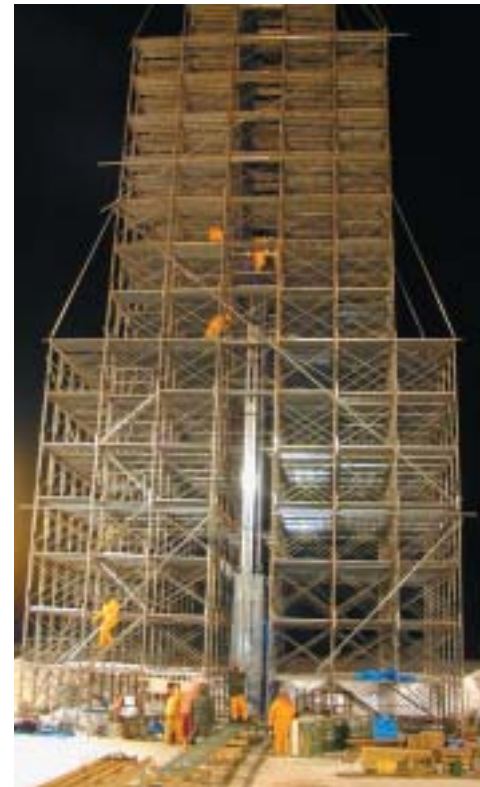
陸別町の掘削実験の足場。中央に4.5mの氷柱を置きドリルを試した。
