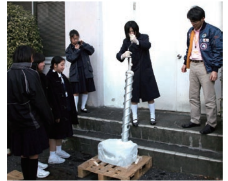
図2 厚い氷のブロックから手回しアイスオーガーで氷柱を採取した。
