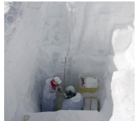
4mピットを用いた雪氷断面観測
