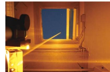
ナトリウム原子観測用のレーザー光を天井の窓から照射している様子。上空90km付近のナトリウム原子からの散乱光で、上空の温度が高精度に観測できる(信州大学・ナトリウムライダーの写真)
